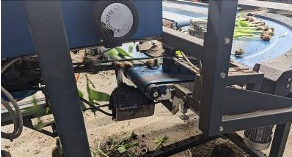
☑このように、ベルトコンベアから運ばれてきたチューリップから、機械で球根部分を取り除き、「切り花」の状態にしたあと
